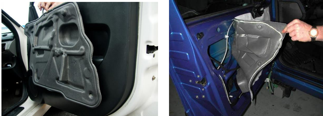
Figura nº 02 – Exemplos de revestimento interno de impermeabilização (“Door Water Shield”) que são utilizados em caixa de porta de veículos automotores.
