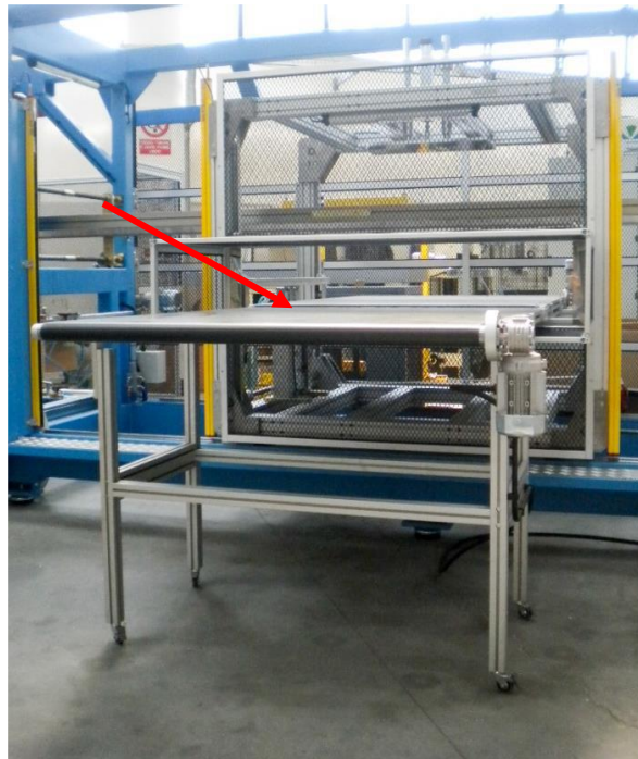
Figura n° 08 - Figura ilustrativa que mostra a esteira de saída de produto acabado e empilhado para o operador (ver no detalhe da foto).
